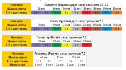
Стропы из полиэстерной ленты (цветные) – достаточно прочные, износостойкие и не вытягиваются под воздействием нагрузки. Полиэстер для строп обладает термо- и влагостойкостью, с него легко удаляются загрязнения, он не подвержен воздействию многих химических веществ.
